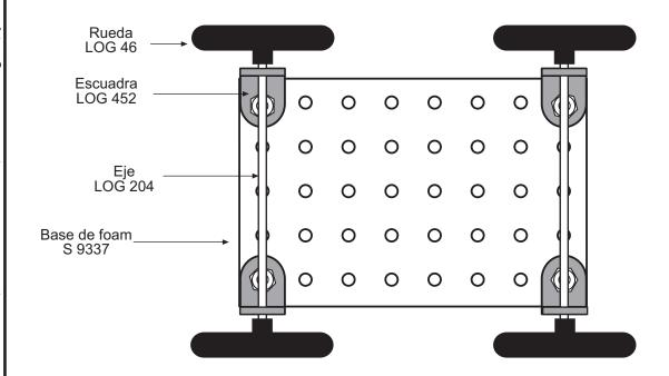
5.3 Dar la vuela al chasis y atornillar el perfil LOG 255 a la base como se muestra en el dibujo, doblar el perfil de aluminio en 45°.
